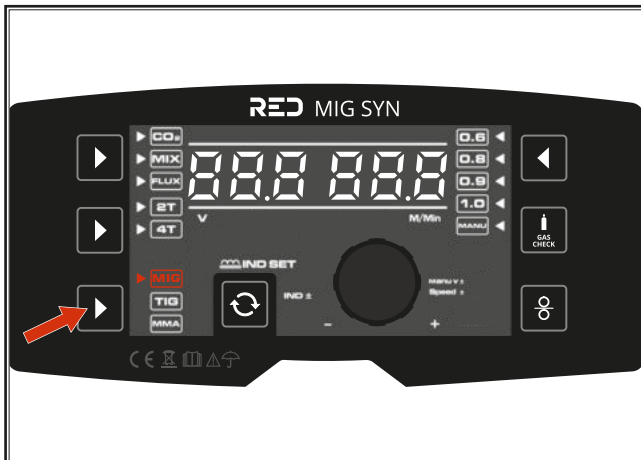
Fig. 9: Impostazione del processo di saldatura
